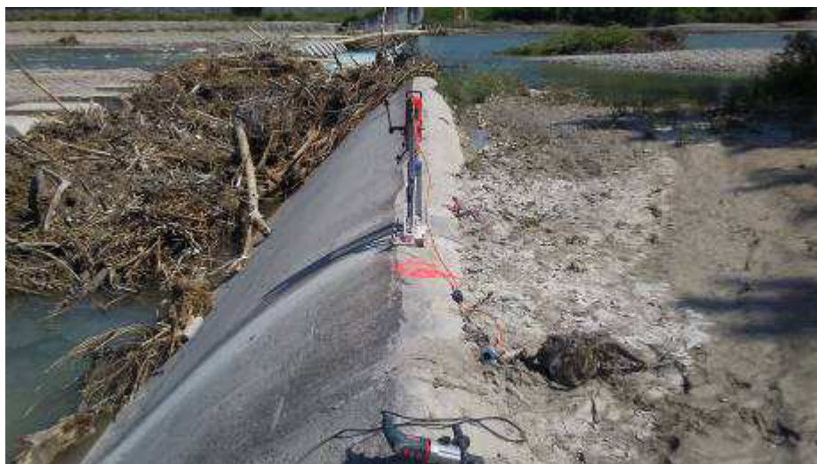
Foto 30. Traversa di Monte. Esecuzione carotaggi protezione
