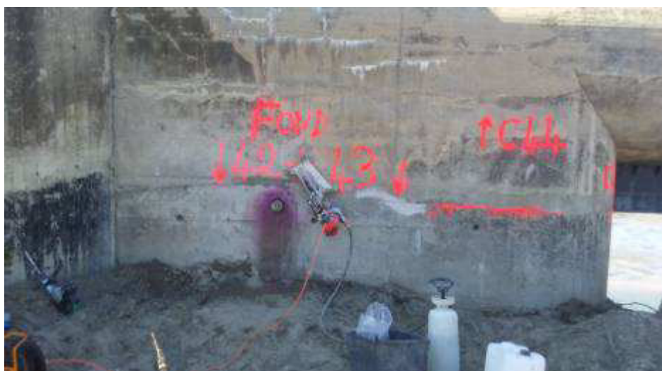
Foto 61. Manufatto limitatore di valle. Manufatto in alveo. Saggio in fondazione
