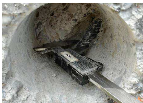
Fig.6.1 – Misurazioni dirette dei diametri e dei copriferri delle armature
