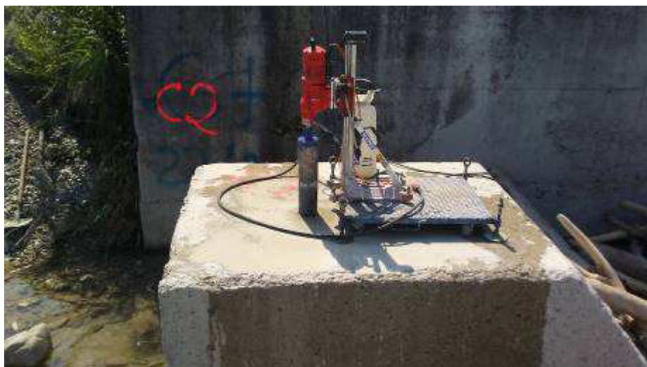
Foto 28. Traversa di Monte. Esecuzione carotaggi
