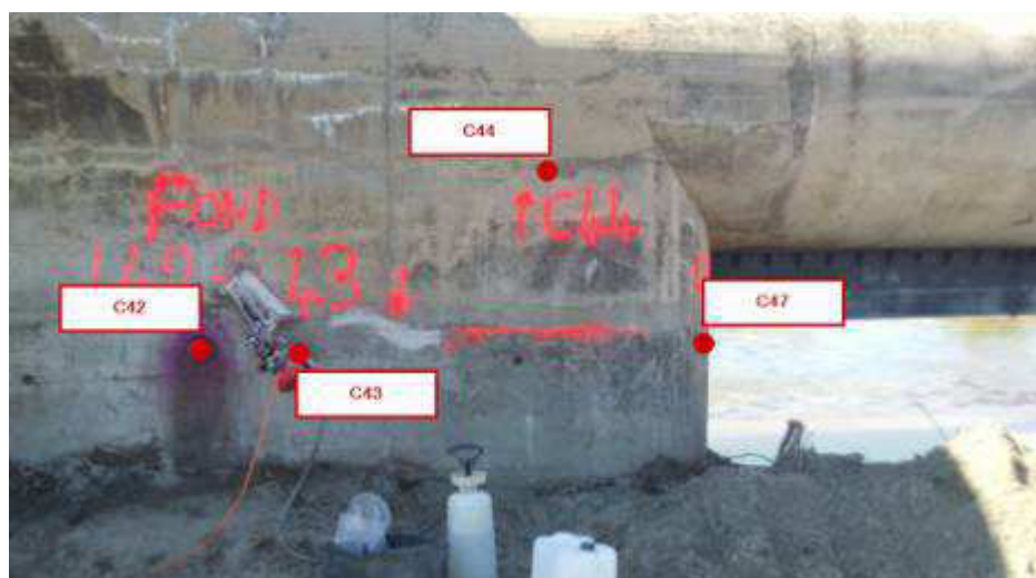
Foto 23. Manufatto limitatore di Valle. Evidenziati in rosso i prelievi delle carote
