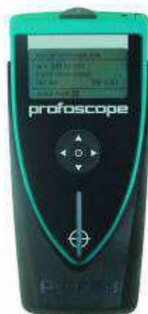
Figura 05. Strumento utilizzato per le indagini (pacometro modello “Profoscope Proceq”).
